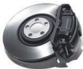
PHANH TRƯỚC 380MM VÀ PHANH SAU 324MM
